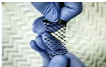
Sopra: Un conduttore estensibile realizzato dai ricercatori dell'università del Michigan.
